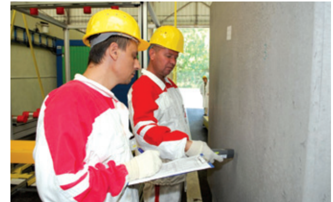
Radijacijska mjerenja na kontaktu stijenke paketa s otpadom, izvor: JAVYS
